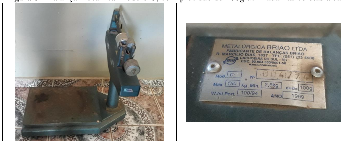
Figura 8 - Balança mecânica Modelo C, com precisão de 100g utilizada nas coletas a campo
